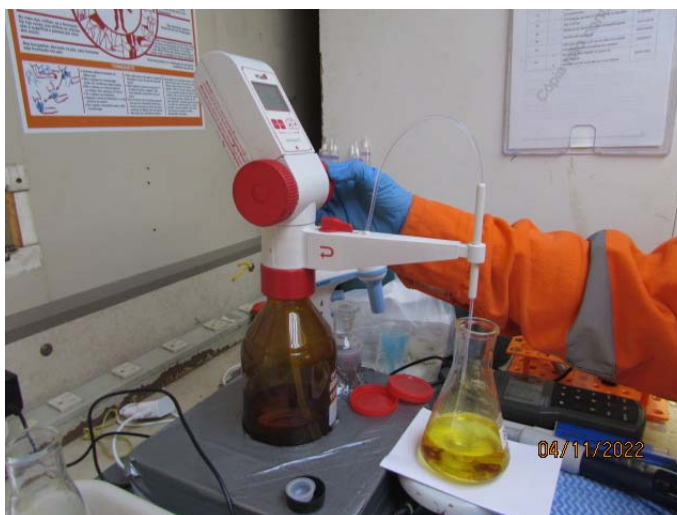
Figura IV.2.1-1 – Determinação de Oxigênio Dissolvido (OD) pelo método de Winkler
